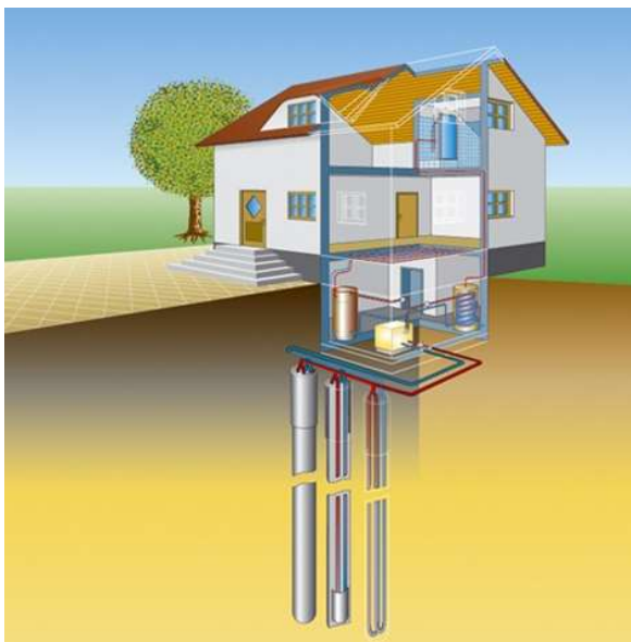
Erdwärmesonde für ein Einfamilienhaus, Quelle: Bundesverband Wärmepumpe (BWP) e. V.
